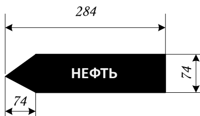
Рис. Е.1 Направление потока нефти однонаправленное, вариант 3 по ГОСТ 14202-69
