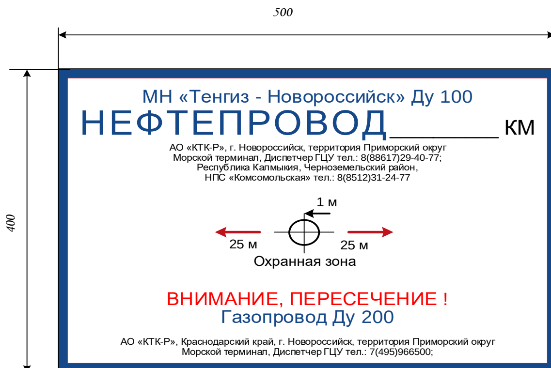
О.9 – Знак пересечения с газопроводом
